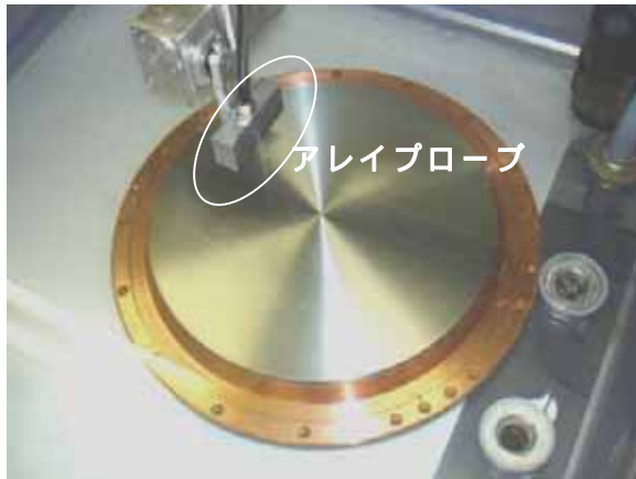
写真 4：ターゲット材の探傷状況
